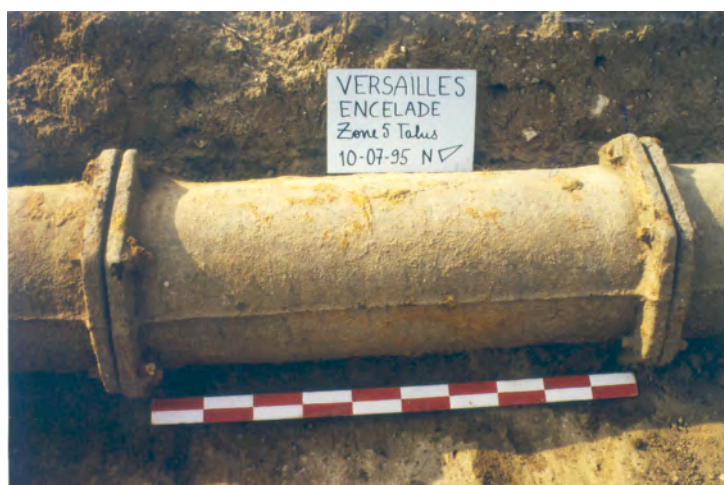
Fig. 73 : Canalisation en fonte datable de 1718-1719, mise au jour lors des fouilles du Bosquet de l'Encelade menées par Annick Heitzmann en 1995 © A. Heitzmann/Centre de Recherche du Château de Versailles
