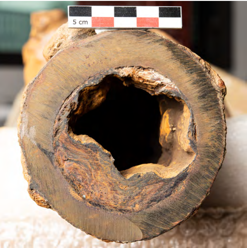
Dépôt lité à l'intérieur du tuyau (échelle 1/1)
