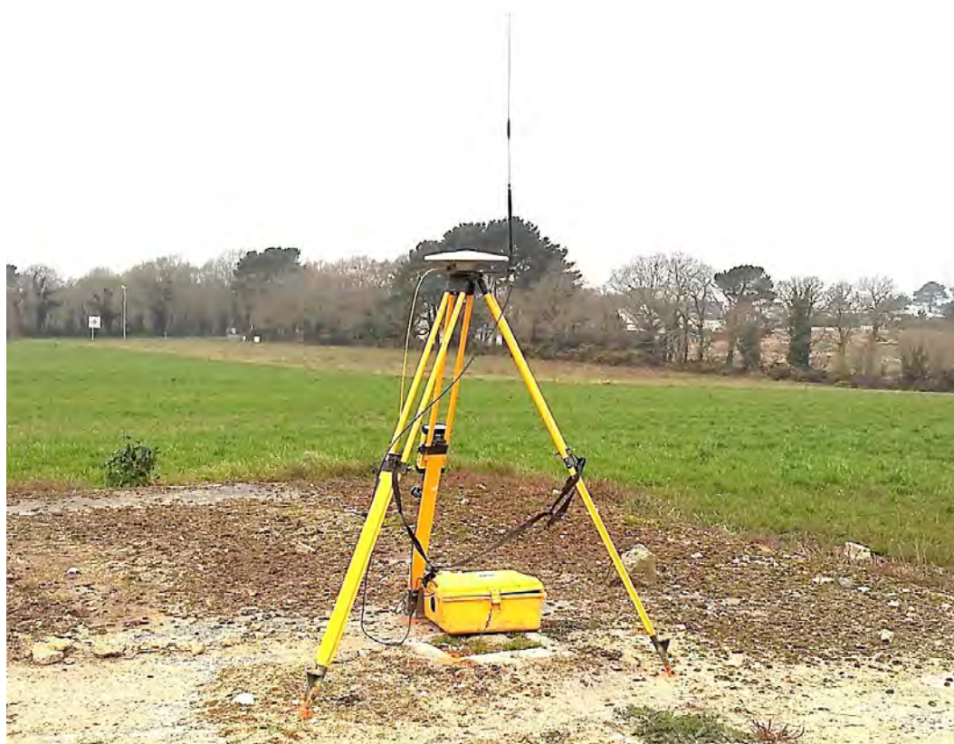
fig. 12 : Base GNSS RTK de la marque Trimble (© Géocarta)
