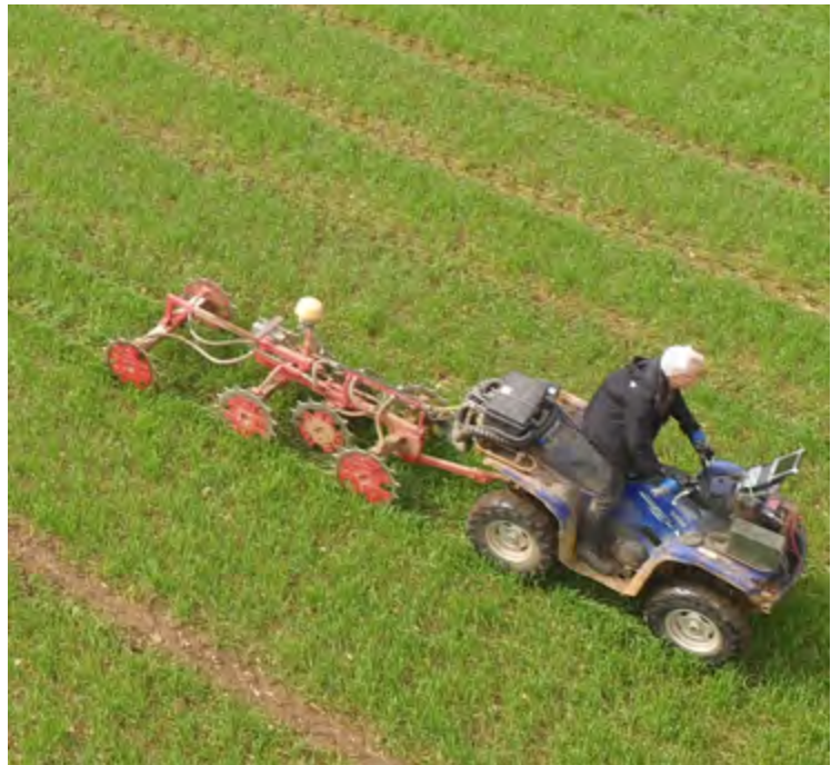
fig. 7 : Dispositif tracté ARP (© Géocarta)
