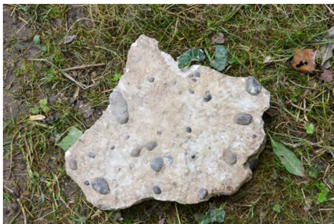
fig. 31 : Fragment de béton de caillles retrouvé en remblais dans le sondage S.X - © C. Travers
